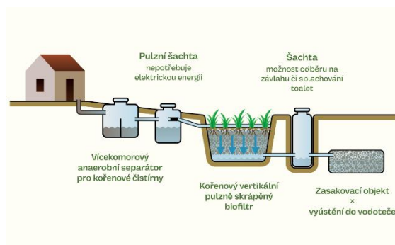
Obr. 8: Schéma fungování zvolené kořenové čističky u domu
